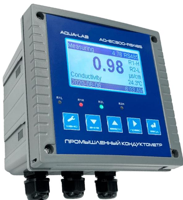
Быстрота измерений, ручная и автоматическая компенсация температуры, позволяет легко и точно определить значение в воде. Прибор обладает сильной помехоустойчивостью
