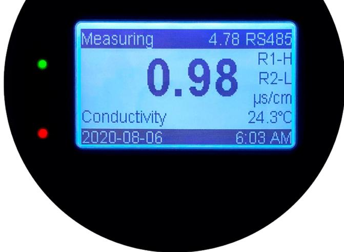
помещении, где отсутствует освещение. Два индикатора реле слева от экрана, позволят наглядно контролировать работу подключенных устройств в заданных режимах
